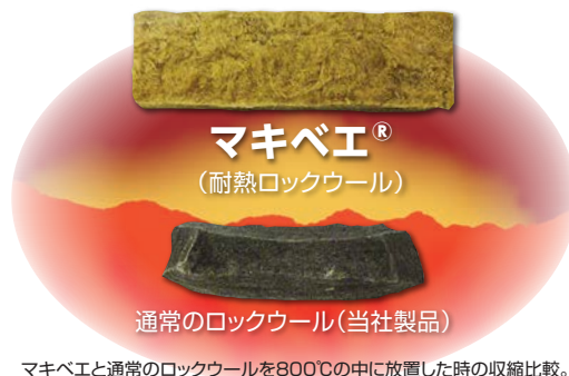
マキベエと通常のロックウールを800℃の中に放置した時の収縮比較。
