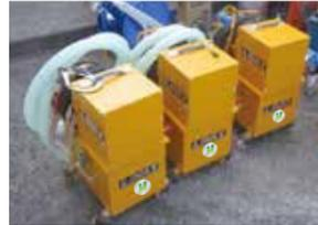
コンクリートの削孔、ケレン時の粉塵を飛散させないように、当社でも改良を重ね、粉塵の飛散を格段に抑制した環境配慮型の集塵機。
