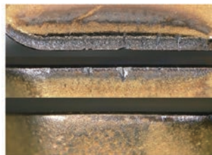
切削長さ2mで熱亀裂からチッピング
