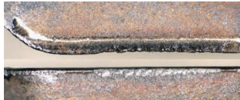
摩耗が進行し母材が露出
