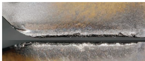
切削長さ3.6mで剥離チップングが発生 従来品
